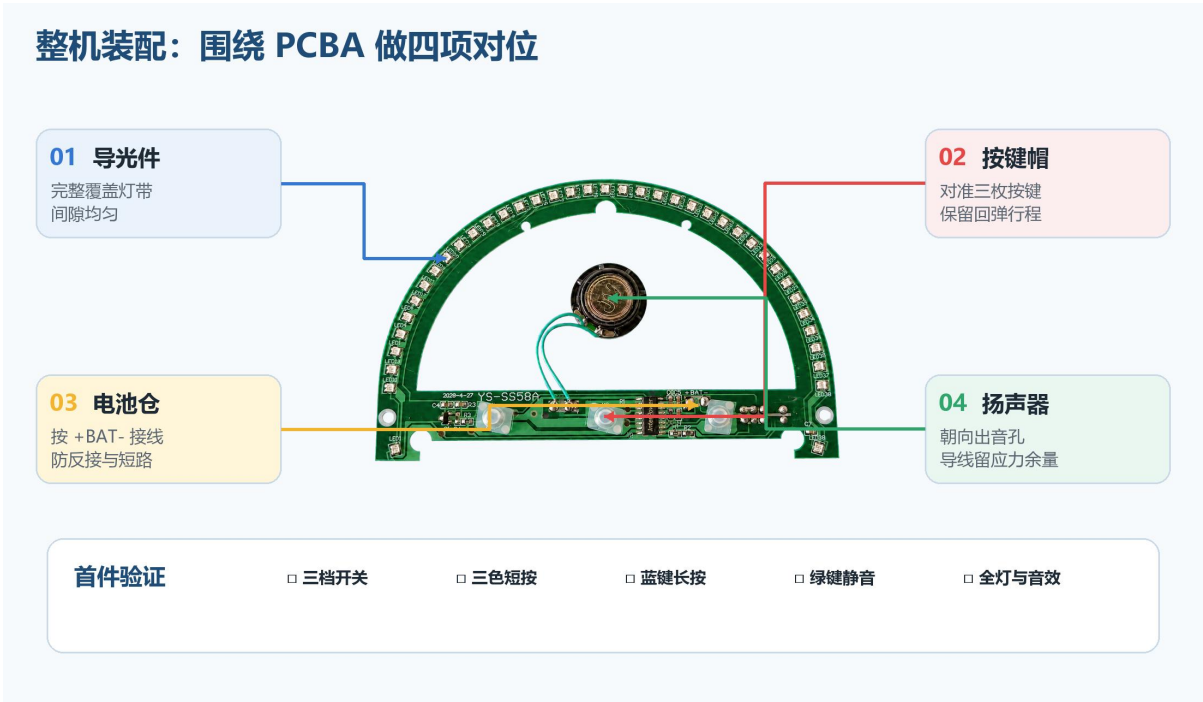
图5 导光、按键、电池与扬声器装配关系
