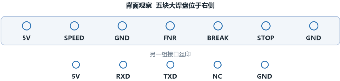
图 6 控制与调试端口丝印示意 图中 BREAK 保留板上原标识
