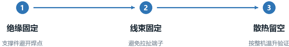
图 5 安装时同时处理绝缘 线束受力和散热
